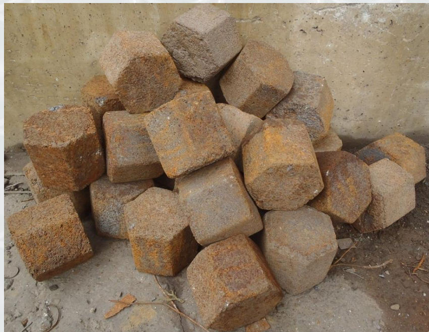
Fe-C brikety experimentálne použité ako náhrada surového železa
